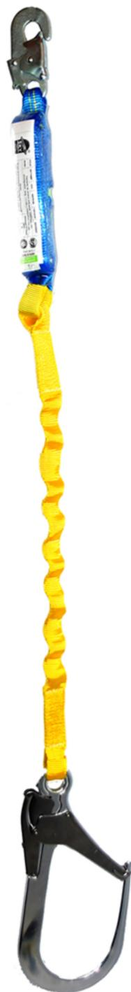
*Elemento de amarre anticaídas elastizado de 1,5 m de largo con amortiguador y 1 mosquetón estampado de 18 mm y 1 de 110 mm*
