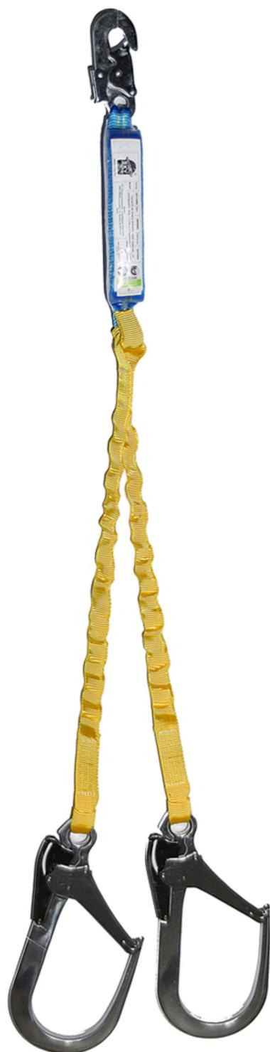
*Elemento de amarre anticaídas doble elastizado de 1,5 m de largo con amortiguador y 1 mosquetón estampado abertura 18 mm y 2 de abertura 110 mm*
