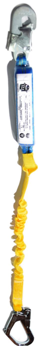
*Elemento de amarre anticaídas elastizado de 1,5 m de largo con amortiguador y 1 mosquetón estampado de 18 mm y 1 de 55 mm*
